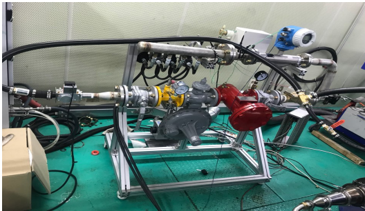
Fig. 3 Gas Flow Meter
