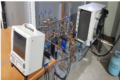
(d) Heat pump and data acquisition module
